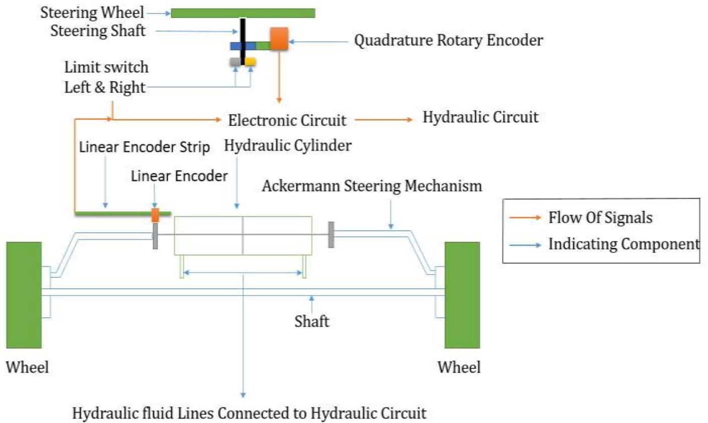
FIGURE 2: ACTUAL COMPONENT POSITIONAL SYSTEM
