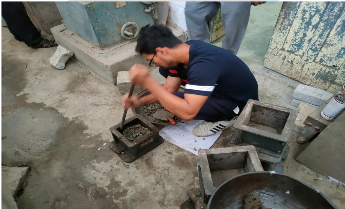
Fig: 4.1 Cube Casting
