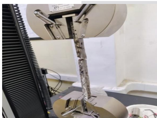
Fig.2.1.2 a Tensile Testing Specimen 1
