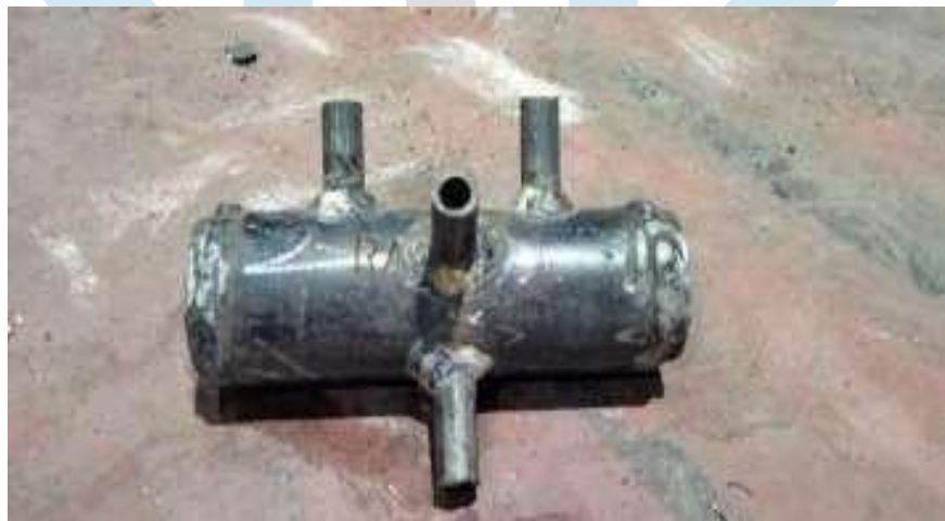
Fig. Outlet Header
